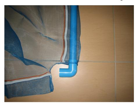
Anschließend wird auf das Rohr- Ende, ein T-Stück (d 25 mm) gesteckt, so dass weitere Rohre verbunden werden können. Auf den kürzeren Seiten des Hälterungsnetzes, werden PVC – Rohre (d 25 mm, Länge 38 cm) verwendet. Diese Rohre werden ebenfalls wieder durch die Laschen des Hälterungsnetzes geführt.
