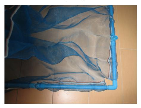
Nun werden auf den freien Stellen der T- Stücke weitere Rohre angebracht. Hierzu verwendet man die PVC – Rohre (d 25 mm, Länge 28 cm).
