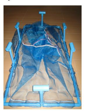
Nun wird wie zuvor, mit Hilfe der PVC – Rohre (d 40 mm, Länge 60 cm) & (d 40 mm, Länge 38 cm) ein rechteckiges Gebilde zusammen gesteckt.
