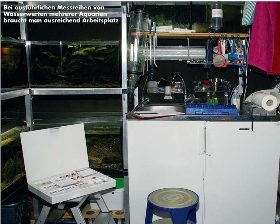
Check-2-Kofferset hat. Der muss noch keine Mess- oder Probenröhrchen ausspülen, denn es werden 12 Röhrchen mitgeliefert. Zwischendurch ist jedes Mal der einzige Messlöffel zu reinigen, damit die Proben und die Reagenzien nicht verunreinigt werden. Auch die Messsonde mit den Linsen sollte nach jeder Messung gründlich mit deionisiertem („destilliertem“) Wasser abgespült werden.
